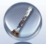
Formazione di calcare in seguito alla durezza temporanea da carbonati eccessiva dell'acqua
