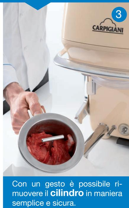
Con un gesto è possibile rimuovere il **cilindro** in maniera semplice e sicura.
