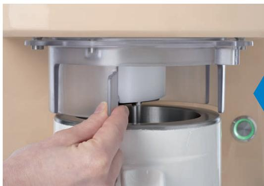
Arresto immediato dell'aggitatore in caso di apertura del **coperchio di protezione** durante la mantecazione.
