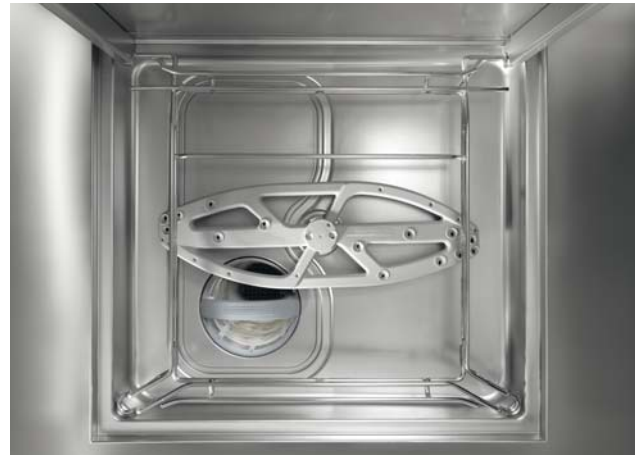
Parte interna della macchina con zona di lavaggio (vista dall'alto)
