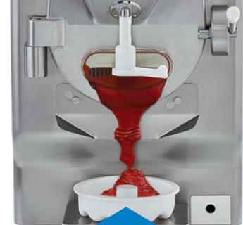
Grazie al **distanziale**, che può essere montato in qualsiasi momento, è possibile ridurre l'apertura dello sportellino di uscita facilitando così l'estrazione del prodotto Crystal e il lavaggio macchina.
